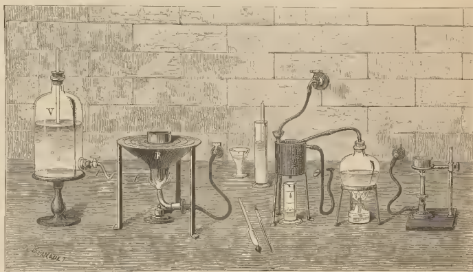
Fig. 3. Aparatos para el análisis de los vinos. - 1. Determinación de la cantidad de extracto seco. V, Vaso de Mariotte. B, Baño maría. - 2. Determinación de la cantidad de alcohol (Aparato de Sallerón). - 3. Determinación de la cantidad de cenizas
